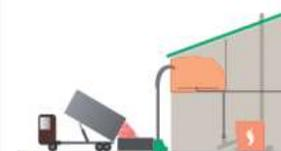
Silo en hauteur accessible par souffleur ou convoyeur ascensionnel HEIZOTRANS et alimentation de la chaudière au niveau inférieur par tube de chute.
