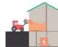
Silo en hauteur et alimentation de la chaudière au niveau inférieur par tube de chute.
