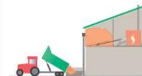
Silo en étage comme la chaudière, remplissage par souffleur ou convoyeur ascensionnel HEIZOTRANS.
