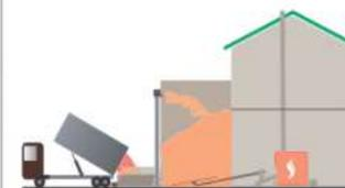
Silo de plain-pied avec remplissage par souffleur ou convoyeur ascensionnel HEIZOTRANS
